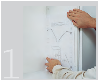
1 Anbringung der Anschlagzeichnung, so daß sie am Boden und an der Rückwand des Möbels anliegt.
