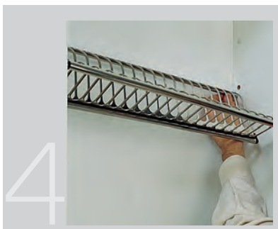
4 Durch seitlichen Druck auf die Zapfen, geben diese nach und ermöglichen eine schnelle Montage im Möbel.
