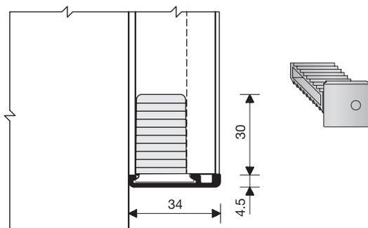
Junta de unión para perfil lateral.
