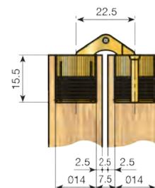
**Bisagra oculta cilíndrica de 16 Ø mm.**
