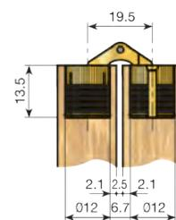
**Bisagra oculta cilíndrica de 14 Ø mm.**
