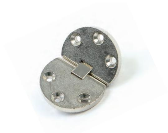
**Colocación:** Se efectúa el alojamiento en una sola operación con una broca de dos diámetros, después se introduce la bisagra y se atornilla con tirafondos.
