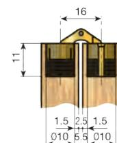
**Bisagra oculta cilíndrica de 12 Ø mm.**
